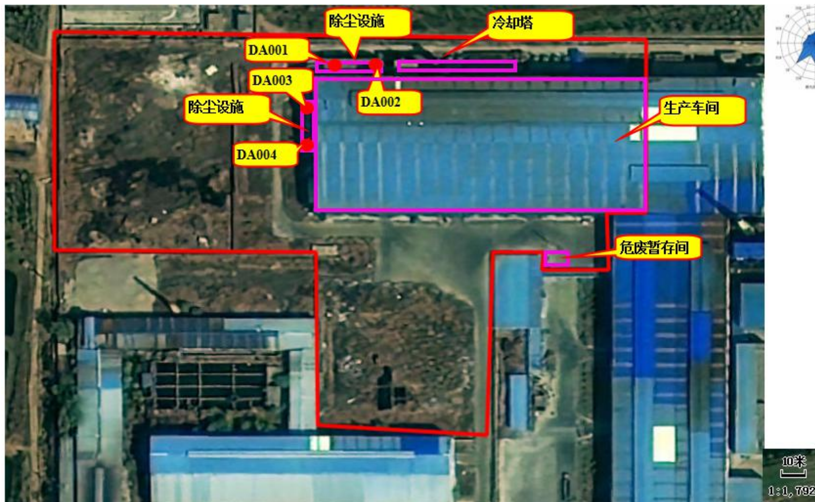
图4 厂区平面布置图 比例尺 1:1000
