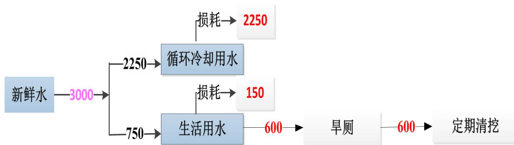
图 6 一期项目水平衡图 单位 (t/a)
